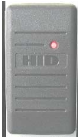
Figura 2-16 LED Bicolore in un dispositivo di sicurezza
