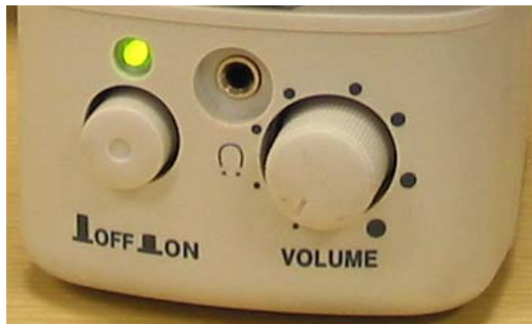
Figura 5-1 Regolatore del Volume in un Altoparlante
