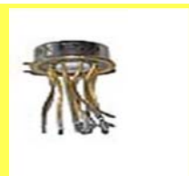
Un amplificatore operazionale u741
