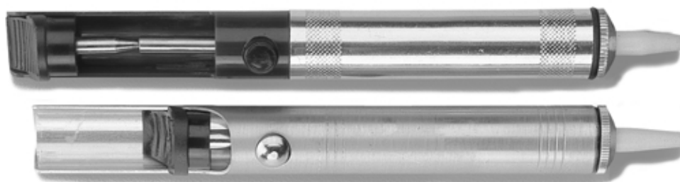
Fig.170 Il "succhiastagno" è una pompetta provvista di uno stantuffo che provvede ad aspirare lo stagno fuso quando si aziona il pulsante della molla di richiamo.
