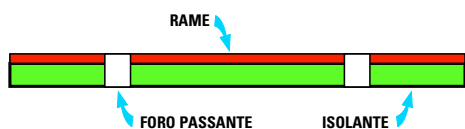
Fig.151 Vengono chiamati circuiti stampati MONOFACCIA quelli che hanno le piste in rame poste da un solo lato della basetta isolante utilizzata come supporto. I circuiti stampati professionali utilizzano come supporto isolante la vetronite.
